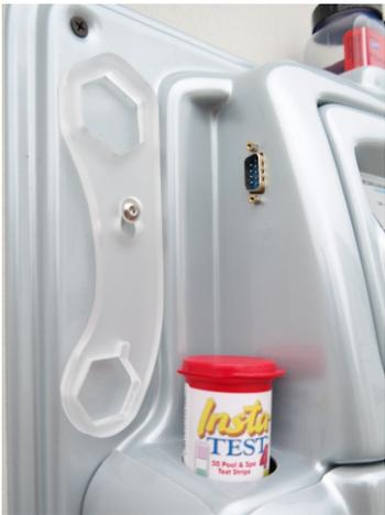
RS-232 Schnittstelle für den Anschluss eines LAN-Internet-Interface-Moduls ( Dazu wird ein externe WLAN-Repeater oder auch nur ein LAN Kabel mit Internetzugang benötigt ! )
